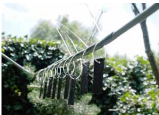
Ryc. 5. Kilka z kilkudziesięciu próbek z antykorozyjnymi powłokami. Fot. Marek Kołyszko
