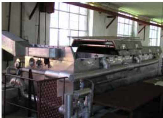
Ryc. 15. Ogrzewana wanna do konserwacji mokrego drewna metodą PEG-ową. Fot. Irena Jagielska
