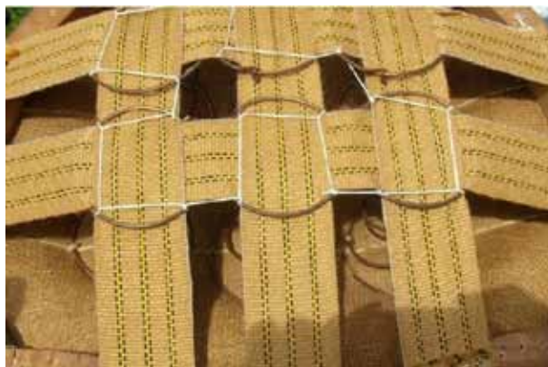
Ryc. 7. Warstwa podtrzymująca: taśma tapicerska (tkana, tzw. parciana) przelatana krzyżowo. Fot. Julia Lange
