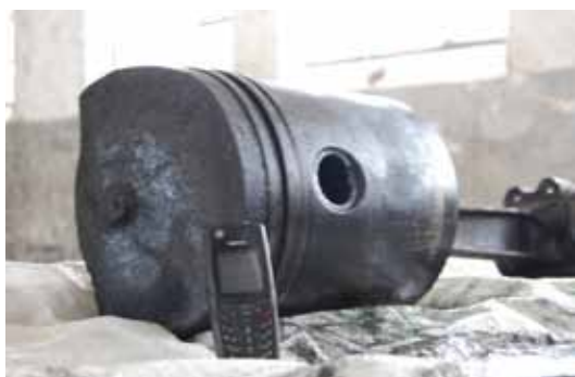
Ryc. 3. Tłok po wyjęciu z cylindra (porównanie wielkości z telefonem komórkowym). Fot. Damian Budzyna
