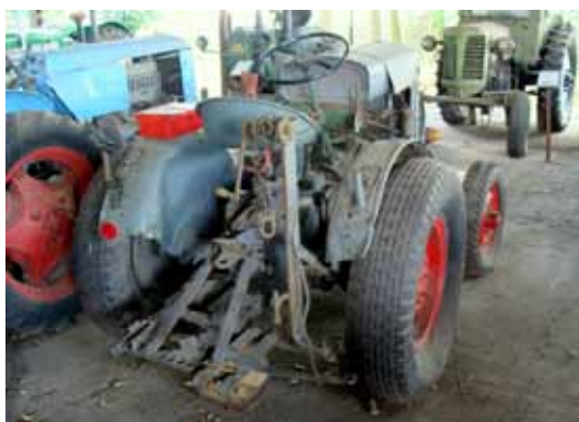
Ryc. 2. Ciągnik Deutz F1 z dobudowaną wyciągarką, Muzeum Narodowe Rolnictwa i Przemysłu Rolno-Spożywczego w Szreniawie. Fot. Tomasz Dzikowski
