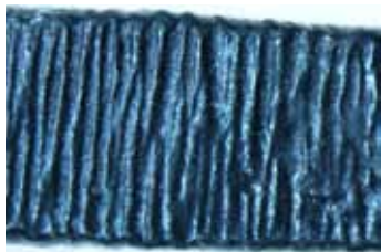
Ryc. 5. Zdjęcie mikroskopowe zębów pilnika z Korytnicy. Fot. Aleksandra Rowińska
