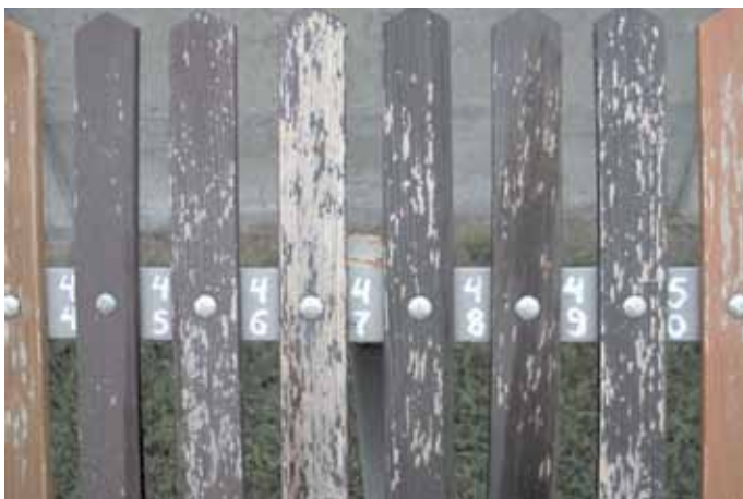
Ryc. 4. Ślady zgrzyzionej powierzchni ochronno-dekoracyjnej oraz elementów anatomicznych drewna sosny, dokonane przez osy na desce ogrodzenia (tzw. plamy liszajowate). Fot. Jarosław Schneider
