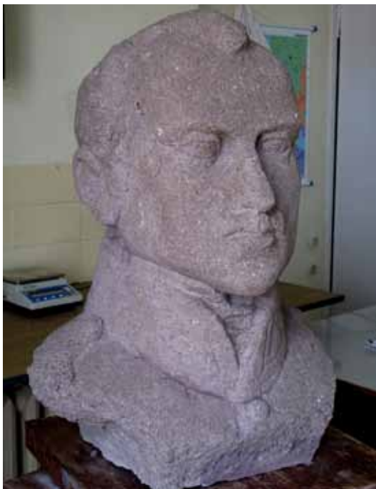
Ryc. 4. Popiersie Chłapowskiego po oczyszczeniu parownicą oraz mikropiaskarką. Fot. Aleksandra Gralińska-Grubecka
