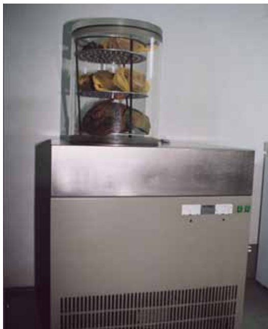
Ryc. 16. Konserwacja drewna w aparaturze próżniowej firmy Heto. Fot. Ewa Meksiak
