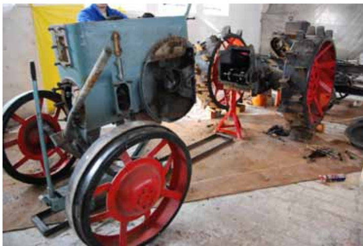
Ryc. 4. Rozłączenie bloku silnika i obudowy skrzyni biegów. Fot. Damian Budzyna
