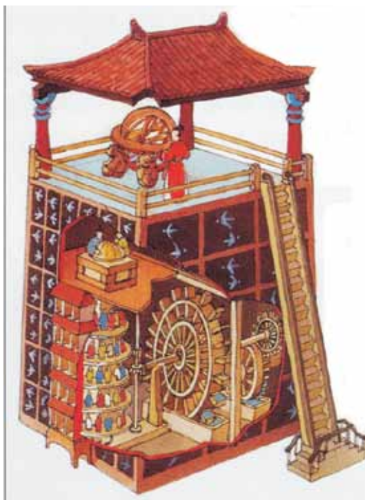
Ryc. 1. Model zegara z napędem wodnym chińskiego cesarza Su Songa, skonstruowany w Kaifeng, 1090 r. n.e.
