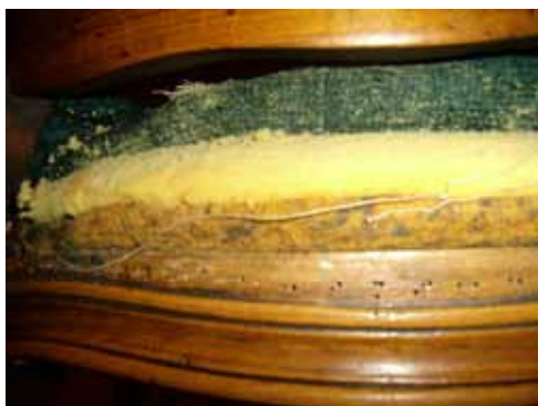
Ryc. 10. Warstwa wyściełająca: pianka poliuretanowa. Fot. Julia Lange
